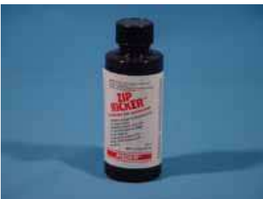
Versneller, onmisbaar bij het gebruik van CA lijmen, hard de lijm onmiddelijk uit. Best spaarzaam te gebruiken, kan de plastic aantasten. Geharde CA krimpt niet en moet direct opgeschuurd worden, wacht je te lang dan is hij steenhard!
